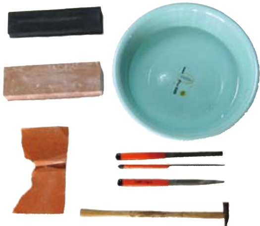
■めのうの加工に使用した道具、砥石（荒）、（細）、たらい、サンドペーパー、ヤスリ、金槌
