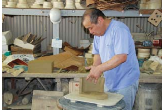
■慣れた手つきで鬼瓦を製作する宮本さん。見る見る形ができてあがっていく。
