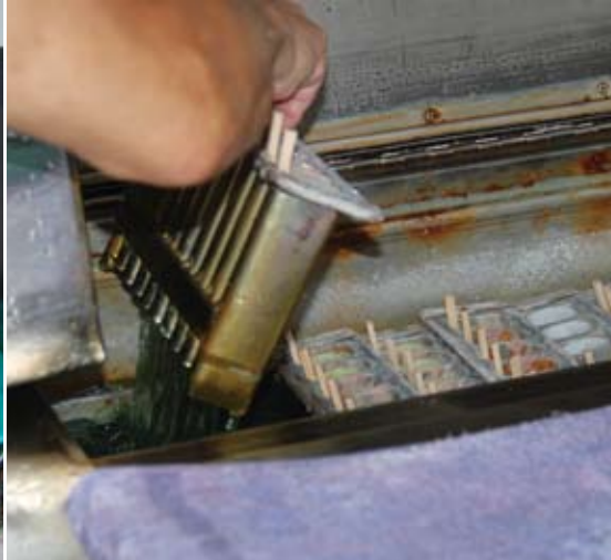
■ (左上) アイスキャンデーの原液を型枠に入れる。(右上) 割り箸を入れる。(右下) 凍結完了。冷却水から取り出す。(左下) 型枠からアイスキャンデーを取り出す。
