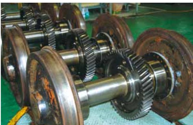
■（上段）車輪の検修をしているところ。（下段）検修待ちの車輪たち。
