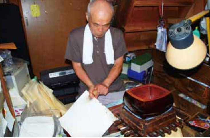
■三味線の皮を張る様子。ご主人が手に持っておられるのが木栓。専用の台に置いてある三味線の胴。
